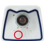
Die LED blinkt jetzt ein Mal und wiederholt dieses Blinksignal nach einer Pause von einer Sekunde (die Anzahl der Blinksignale entspricht der aktuell auswählbaren Boot-Option). Betätigen Sie den Taster erneut kurz (< 1 s), um zur nächsten Boot-Option zu wechseln. Nach der letzten Boot-Option wird wieder die erste angezeigt (1 x blinken).
