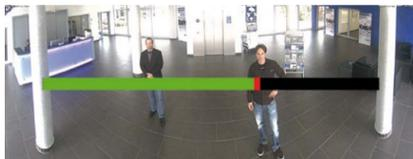
Drehen Sie das Objektiv mit der Hand vorsichtig hin und her, bis der rote Bereich der Scharfstellhilfe möglichst vollständig verschwunden ist.
