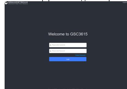
6. Имя пользователя и пароль необходимы для подключения и управления камерой. Имя пользователя по умолчанию - «admin»; пароль по умолчанию - это случайный пароль, напечатанный на наклейке, которую можно найти на корпусе камеры и на обороте краткой инструкции.
