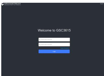
6. Le nom d'utilisateur et le mot de passe sont nécessaires pour se connecter à la caméra afin de gérer le périphérique. Le nom d'utilisateur par défaut est «admin»; le mot de passe par défaut est un mot de passe aléatoire imprimé sur un autocollant qui se trouve dans le boîtier de l'appareil photo et à l'arrière du QIG.
